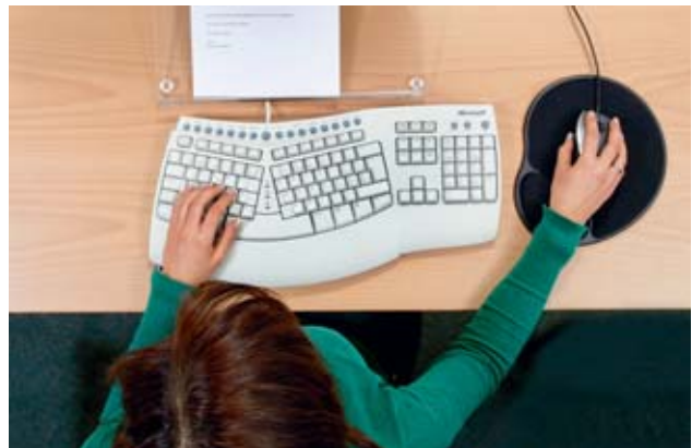
Fig. 14: Clavier avec pavé numérique bombé. Il faut écarter le bras.
